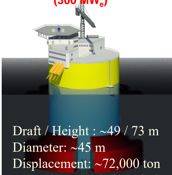
OFNP-300 (300 MW e )
